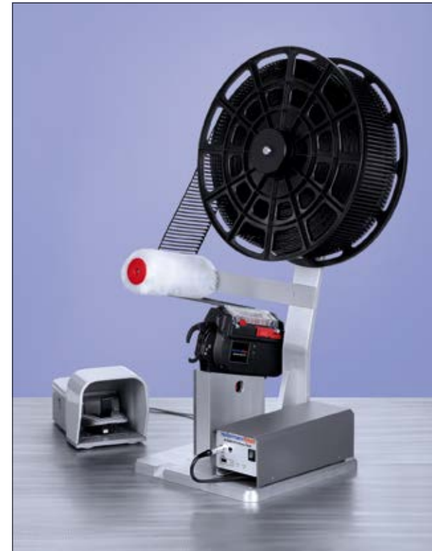
Zestaw do mocowania stołowego: Pedal, narzędzie Autotool 2000 CPK, zasilacz sieciowy CPK i bęben z opaskami T18RA3500.
