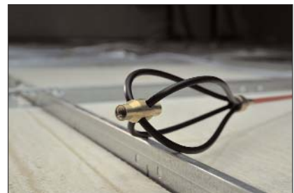
Trzepakzka ułatwia przeciąganie przewodu po nierównej powierzchni.
