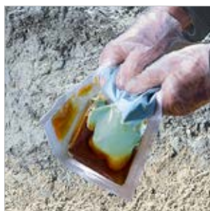
Środkowe uszczelnienie między żywicą a utwardzaczem otwiera się pod naciskiem.
