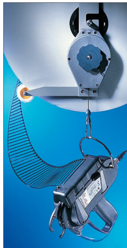
Stanowisko do pracy w podwieszeniu. Widoczna szpula i Autotool 2000.
