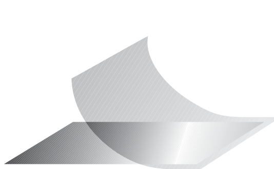
Srebrna tabliczka znamionowa z nadrukiem (Mat. 951A) jest zabezpieczana przezroczystym laminatem (Mat. 951B).
